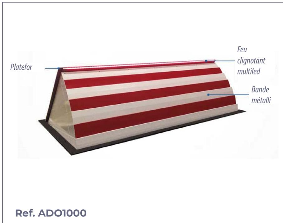
**Bloqueur de route ou Road blocker**, plateforme motorisée, version haute sécurité (PAS68: 2013 Anglais Certification relative à un essai d'impact avec un camion de 7 500 kg à 80 Km/h). Le bloqueur à haute résistance est normalement utilisé pour la protection contre le terrorisme aux niveaux les plus élevés.
