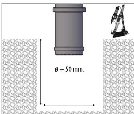
**1.** Percer un trou, de préférence avec un foret diamant ou, à défaut, avec un marteau-piqueur ou rotatif.
