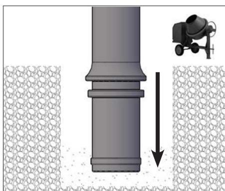
**3.** Introduire la borne dans le trou réalisé et remplir celui-ci avec du ciment.
