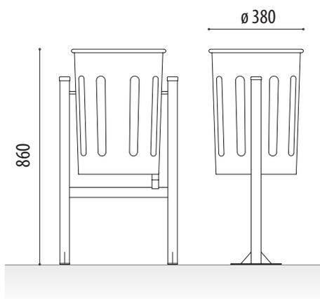
**Cestino portarifiuti modello Life in acciaio,** ribaltabile, di colore nero antracite, con piastra alla base per l'ancoraggio al suolo mediante tasselli metallici.
