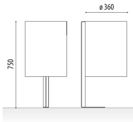
**Cestino portarifiuti modello Sime** in lamiera d'acciaio corten di elevata resistenza e robustezza, struttura di supporto a T, angoli smussati e piastra inferiore per l'ancoraggio al suolo mediante tasselli metallici. Include il procedimento di attivazione del corten sulla superficie esterna.
