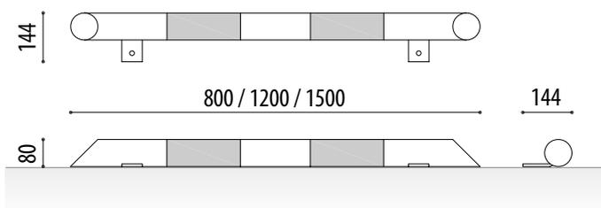
Fermaruota in acciaio modello Dakar che assiste il conducente delimitando il posto auto.
