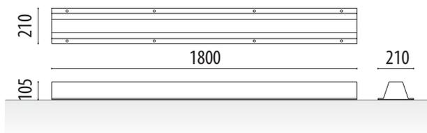
**Fermaruota in acciaio modello Sepang** fabbricato con lamiera d'acciaio galvanizzato, ripiegata a forma di "U" rovesciata, con estremità laterali piane per l'ancoraggio al suolo mediante tasselli metallici. Assiste il conducente delimitando il posto auto.
