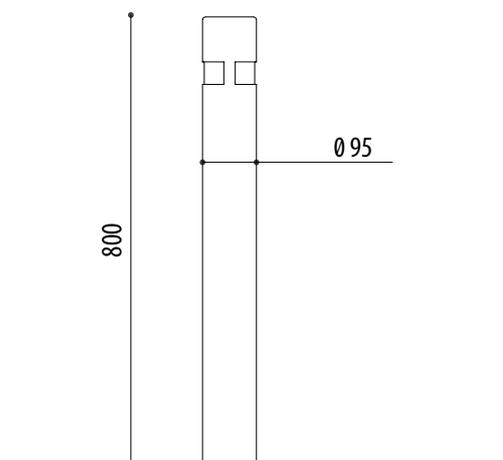
Dissuasore realizzato su richiesta delle amministrazioni locali per risolvere il problema della rottura della parte superiore dei dissuasori ad anello in acciaio inox.
