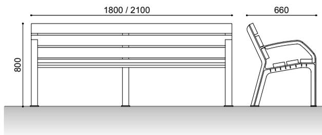
**Panchina urbana modello Eco Alba** composta da 6 doghe in plastica riciclata da 2100x105x45 mm e gambe in plastica riciclabile ad alta resistenza con trattamento anti-UV. Ancoraggio al suolo mediante viti.
