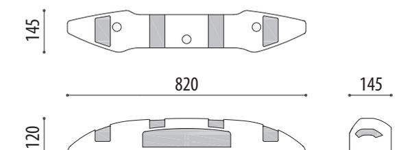
**Spartitraffico modello Pitón realizzato in materiale riciclato** costituito da un'unica unità di 820x145x120 mm. Colore nero e verniciato con microsfere bianche catarifrangenti.
